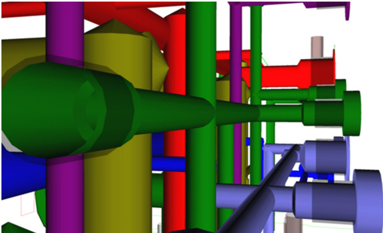
Quando solicitado o projeto especial de Bloco Manifold, nossa equipe de engenharia analisa o circuito hidráulico e layout predefinido pelo cliente. É desenvolvido o projeto em software 3D, checando automaticamente a espessura de paredes entre furos e área mínima de intersecção dos dutos comunicantes.
